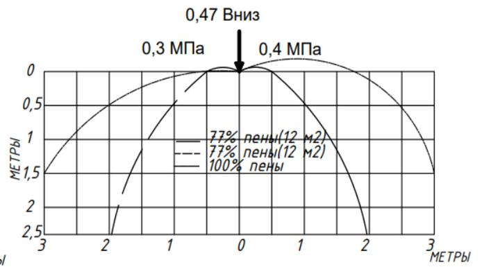
**Графики зависимости интенсивности орошения от давления для оросителей водяных и пенных при высоте установки 2,5 м и площади 12 м<sup>2</sup>**
